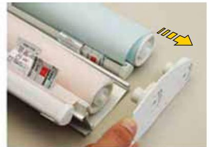
**4** 軸受けブラケットを引き抜いた側の巻取りパイプと、樹脂のキャップの間にマイナスドライバーを差し込んでスプリングモーターを抜き取ってください。
