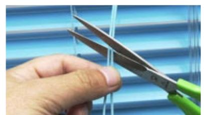
**14** 古い昇降コードからコードイコライザーを取外して、新しい昇降コードに取付けて、抜けないように結び目をつくって組合わせてください。
