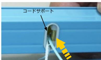
**6** ヘッドボックス内側のコードサポート内に出てきた昇降コードは、写真のように取り回してください。
