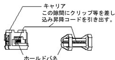
下図のように、クリップ等の先端の曲がっている方に新しい昇降コードの先端を引っ掛け、ゆっくりと引っ張ってください。OPストッパー本体から新しい昇降コードの先端が出てきましたら、昇降コードの方を引っ張り確実に引き出してください。またこの作業は、昇降コード1本ずつ行ってください。2本又は3本の昇降コードを同時に通しますと、ホールドバネを押し広げるばかりでなく、コードが乗り上げた状態になりやすく、ストッパー不良の原因にもつながりますので避けてください。
