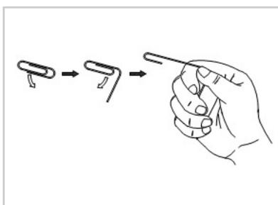
まず最初に、OPストッパー本体の手前からキャリアの中にあるホールドバネ（金色の金物）を確認します。次にクリップ等の先端が曲がっている方をホールドバネの隙間に差し込みます。
