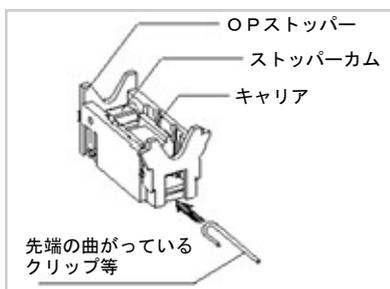
注) この時、ホールドバネの真ん中の隙間ではなく下側や上側にクリップ等を差し込み、昇降コードを通してしまいますと、ストッパー不良の原因になりますので、慎重に確認して作業を行ってください。
