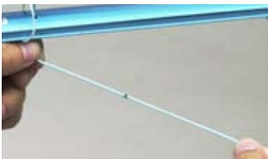
**5** 操作側から新しい昇降コードが出てくるまで古い昇降コードを引き出してください。この時溶着部分が切れないように静かに引き出してください。その後、古い昇降コードの部分をカットしてください。
