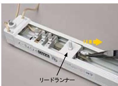
**14** 引出したコードが幅詰めした寸法の1/2の長さだけ短くなるように結び目を作って、この結び目をリードランナーの中に納めてください。
