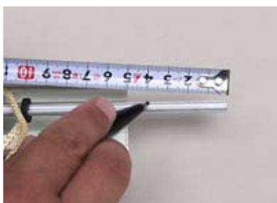
**7** 金ノコでシャフトを切断してください。切断後はヤスリで切断面を整えてください。
