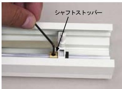
**7** 切断したハンガーレールと同じ長さだけ、シャフトも同様に切断してください。切断後はヤスリで切断面を整えてください。
