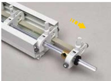
**9** 取外すランナーを連結しているスペーサーをはさみで切断して、スペーサーごと取外してください。
