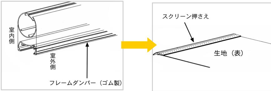
●製品本体を右図のように逆さにして室外側（フレームダンパーのついた側）が手前にくるように置きます。
