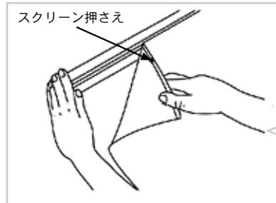
※ブルコード式の場合、巻取りスプリングの初期巻きを解除しないようにして下さい。巻取りパイプを左図の矢印の方向に少し回すとストッパーが解除され、パイプが自動的に逆回転し、初期巻きが解除されてしまいます。生地を取外して、新しい生地を取付けるまでパイプを回さないようにして下さい。
