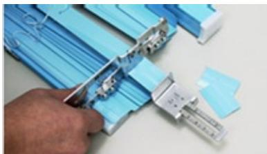
**3** ヘッドボックスとボトムレールを金ノコギリで切断してください。
