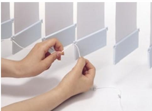
**1** バランスウェイトのツメにボトムコードを引っ掛けます。全てのスラットに引っ掛けた後、余分なボトムコードを切断します。はさみ込み仕様は上から、巻き込み仕様は下から、ボトムコードを取付けます。
