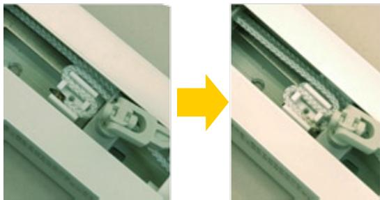
**9** 取外した時と逆の要領で、樹脂部品をセットして、ビスで固定して完了です。
