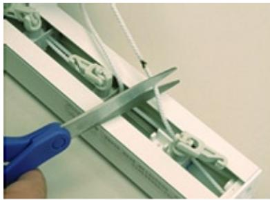
**7** 新しい操作コードの切断部分を、ほどけてこないようにライターの火等であぶって固めてください。
